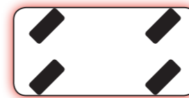
Bogies: 4 bloques de ruedas direccionales.
